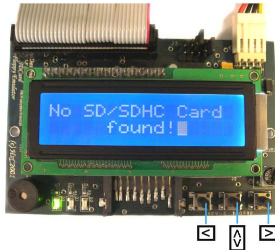
Figure 10 : Première mise sous tension de l'émulateur
